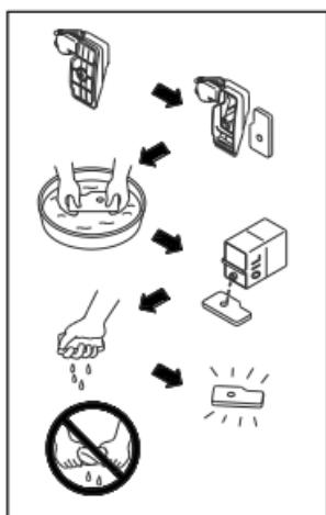
UPOZORNĚNÍ: Motor by nikdy neměl běžet bez tohoto prvku; může způsobit nadměrné opotřebení pístu a/nebo válce.
